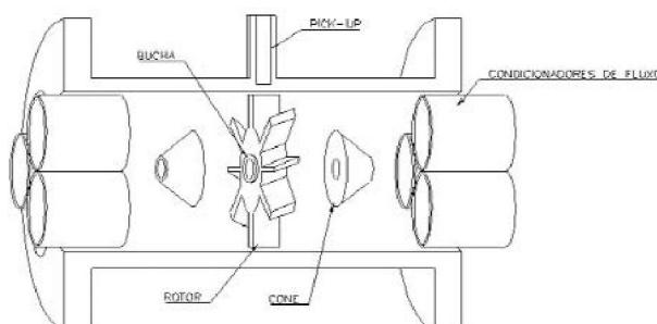
O projeto e fabricação do medidor de vazão tipo turbina da Incontrol leva em consideração detalhes construtivos como:
