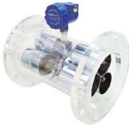
O medidor de vazão tipo turbina para líquidos, por não depender da condutividade do fluido de medição, é utilizado com qualquer tipo de líquido limpo, contudo de baixa viscosidade (limitado a 60 cSt).
