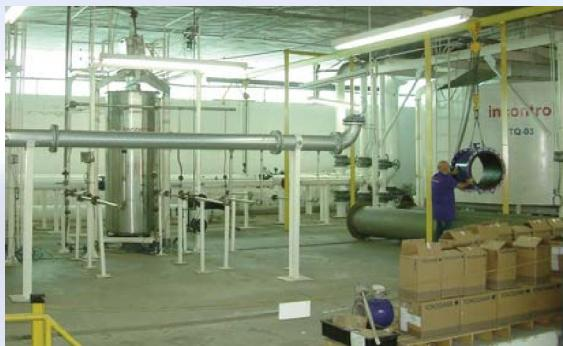
O Laboratório de Vazão Incontrol é hoje uma referência nacional. Todos os padrões primários são rastreados RBC e periodicamente calibrados sob as mais criteriosas condições de qualidade existente. O laboratório atende à norma NBR/ISO/IEC 17025 de laboratórios, ISO 4185 - Laboratório de Vazão de Líquido pelo método Gravimétrico Estático e cálculo de incerteza seguindo a norma ISO 5168. A incerteza de calibração é de 0,10% (fator de abrangência  $k=2$ , nível de confiança = 95%).
